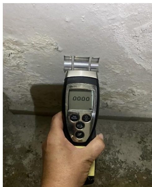
Vlhkost zdiva je v těchto místech nad kapacitu vlhkoměru, což je více než 20 %.
